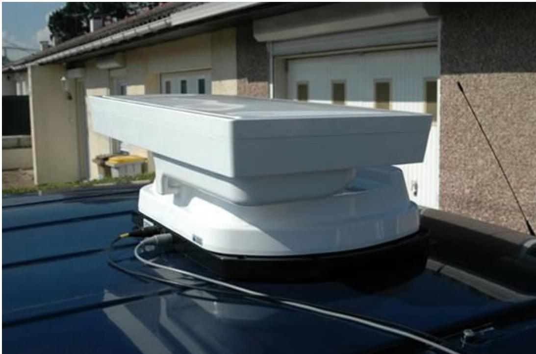
Pour cette démonstration, l'antenne était simplement « posée » ; mais il est bien évident que pour des raisons de sécurité elle doit être solidement fixée au véhicule. Une plaque de fixation est livrée avec tous les accessoires (passage de câbles) pour assurer l'étanchéité sur le véhicule. Dès lorsqu'elle est sollicitée l'antenne va se mettre en mouvement selon trois axes (azimut, élévation et déclinaison) :
